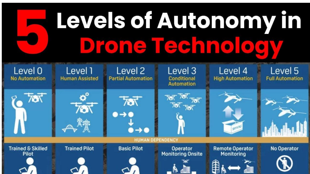
Figure 3.6 : les cinq niveaux d'autonomie dans les technologies des drones
