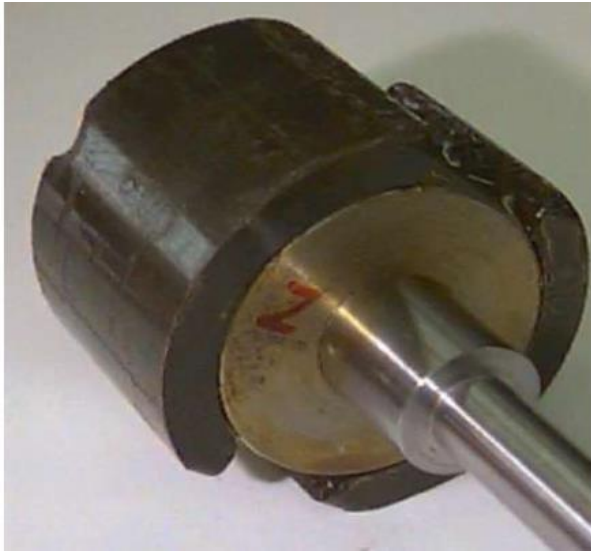
Exemple de rotor à aimants permanents
