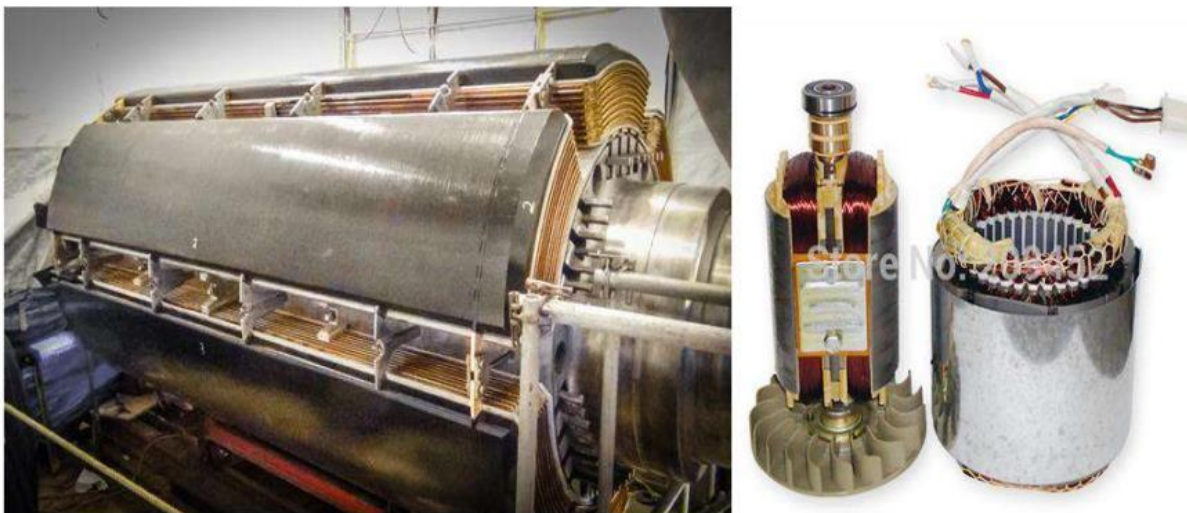
Exemple de rotor bobiné à pôles saillants.
