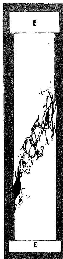
FIG. 11. Essai à la rupture d'un poteau court en B.A. (doc. C.E.S.)
