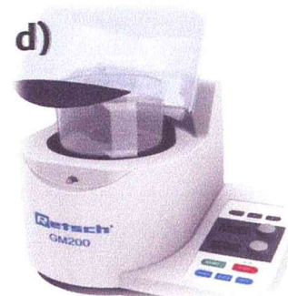
Figure 4.3 : (a) broyeur à main (mortier et pilon), (b) broyeur électrique à pédale type stomacher, (c) broyeur électrique type mortier et pilon, (d) broyeur électrique type à couteaux.
