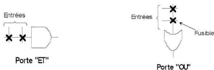
Figure 2. Symbolisation des portes logiques pour les PLD
