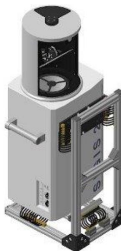
Figure 5.4: Dispositif de détection des gaz atmosphériques SIGIS 2 Bruker
