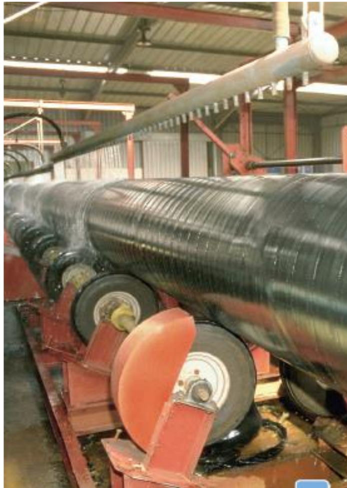
Figure IV. 9. Acier revêtus extérieurement (Veolia, 2009)
