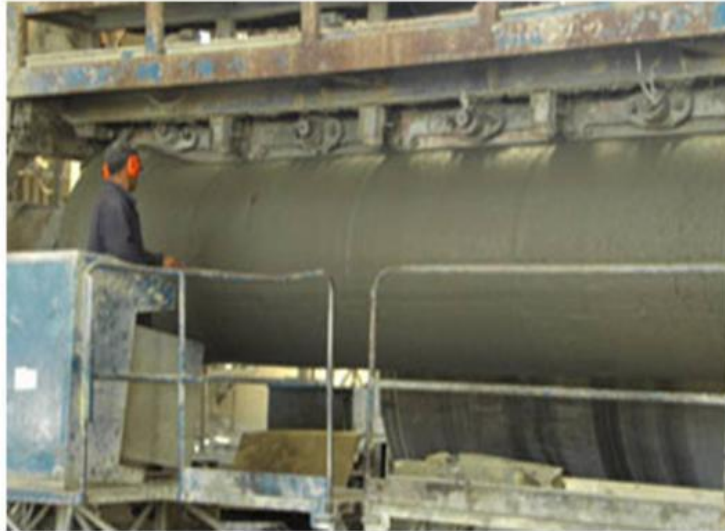
Figure IV. 21. Revêtement des tuyaux à l'aide d'une trémie vibrante
