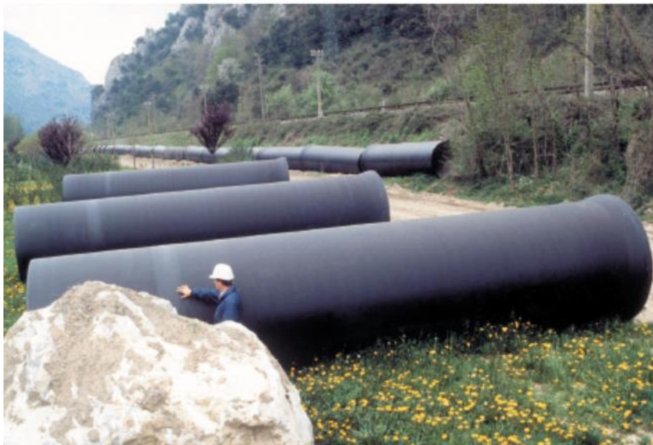
Figure IV. 3. Tuyaux en fonte ductile, zinc + peinture bitumineuse DN 2000
