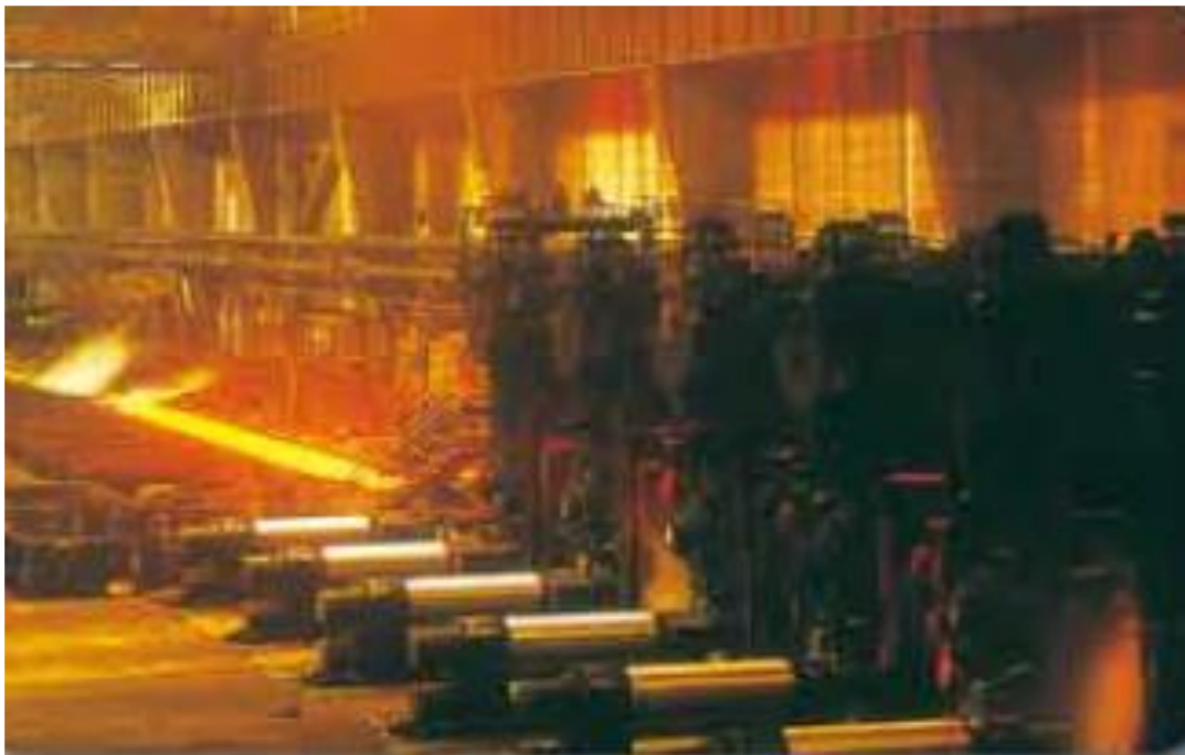
Figure IV. 7. Laminage à chaud de bande (au sol, cylindres en attente d'utilisation) (FFA, 2012)
