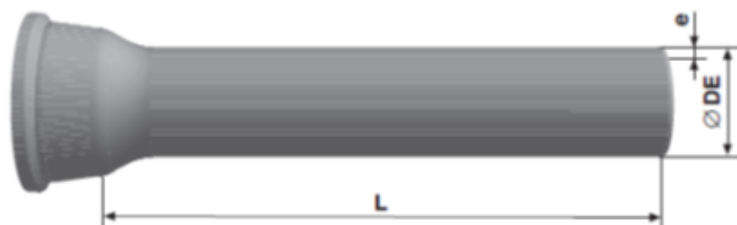
Figure IV. 2. Conduites en fonte protégées par une fine couche de zinc
