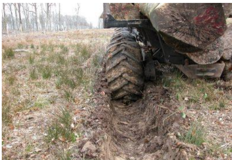
Figure 29. Orniérage occasionné par un débardage en milieu forestier.
