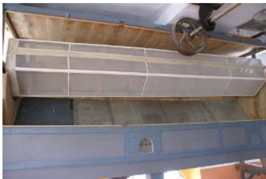
Figure 4 : appareil appelé « plansichter
