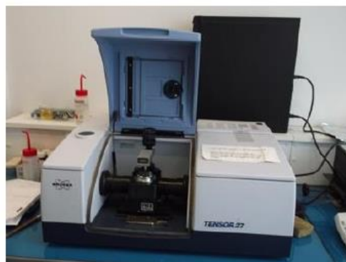
Figure : Principe et appareillage du spectromètre infrarouge
